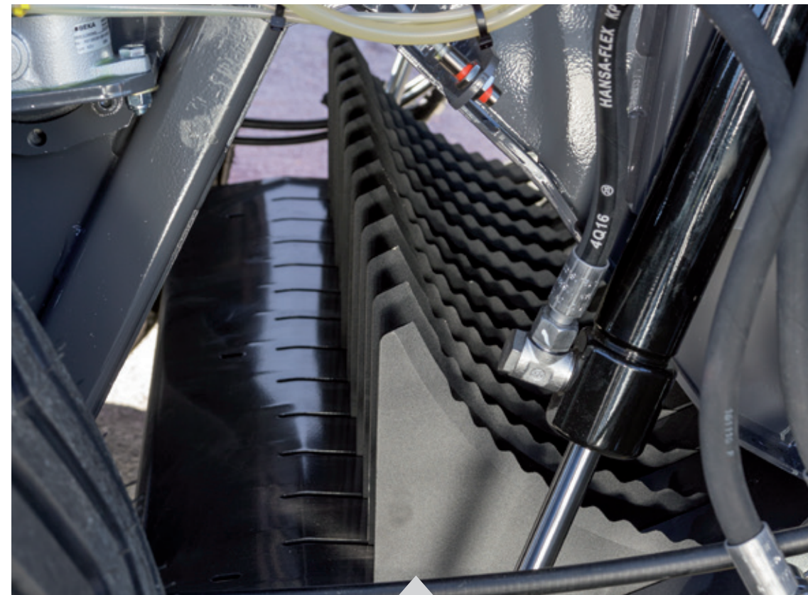
Xtracut 13 -rotor met een snijlengte van 90 mm voor het gewas
