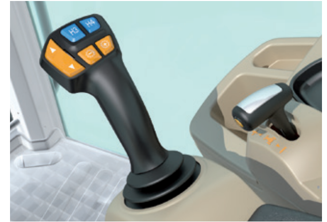
De optionele MF 5700 S Essential cabine met elektronische multifunctionele joystick voor de voorlader
