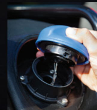
De positie van de AdBlue®-tank is zorgvuldig gekozen voor extra isolatie bij hoge en lage temperaturen. Beide tanks kunnen veilig en gemakkelijk worden gevuld.
