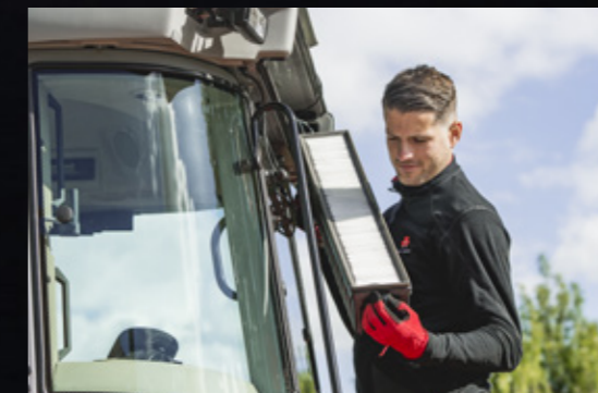
Cabineluchtfilter gemakkelijk bereikbaar om te reinigen.
