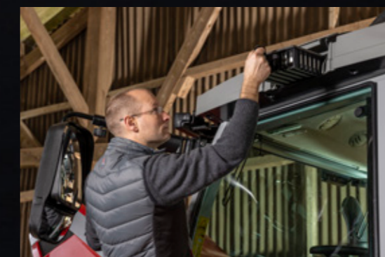
Cabineluchtfilter gemakkelijk bereikbaar om te reinigen.
