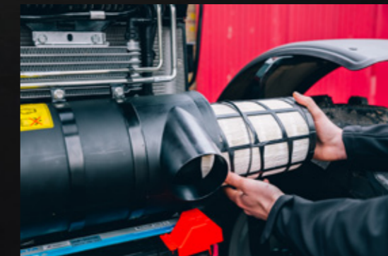
Ook het luchtfilter van de motor is goed bereikbaar en gemakkelijk te reinigen.
